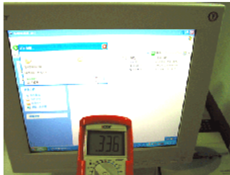
一台新電腦插 2 孔插座的 KB 測試值
